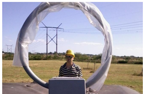
Fig. 2. Lazo activo y línea de alta tensión bajo estudio.
