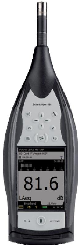
**Figura 16: Sonómetro de banda ancha Clase 1. Fuente Brüel&Kjaer**
