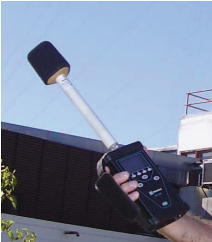
Fig. 3: sensor de campo con visualizador portátil.
