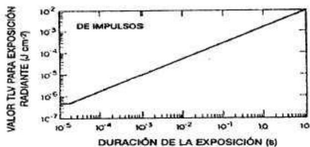
Figura 2 a. Valor TLV para la exposición ocular directa del rayo láser (400-700 nm).
